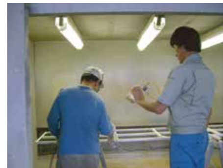
塗装室 空気汚染測定
